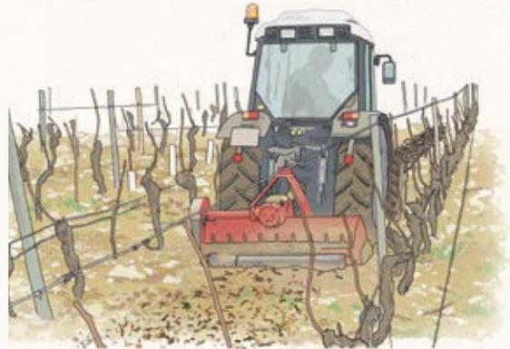
Broyage mécanique dans le rang
